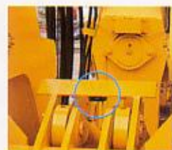
ドラムの巻取り状態 確認用カメラ
